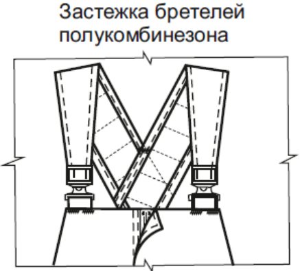
Рисунок Д.2 – Схема расположения закрепок полукомбинезона и брюк для костюмов рабочих и ИТР
